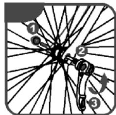
Posicione a ponta do garfo no eixo da roda. Retire a porca da blocagem (1) e passe o eixo da blocagem dentro do eixo da ro-
