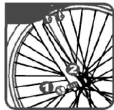
Remova o protetor de plástico do eixo da roda. Com uma chave de boca 14mm, retire as porcas externas do eixo (1).
