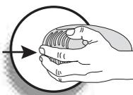
✓ Desenrosque a lâmpada e substitua por uma nova, com as mesmas características, de no máximo 15 Watts, que você também encontra no serviço autorizado.
