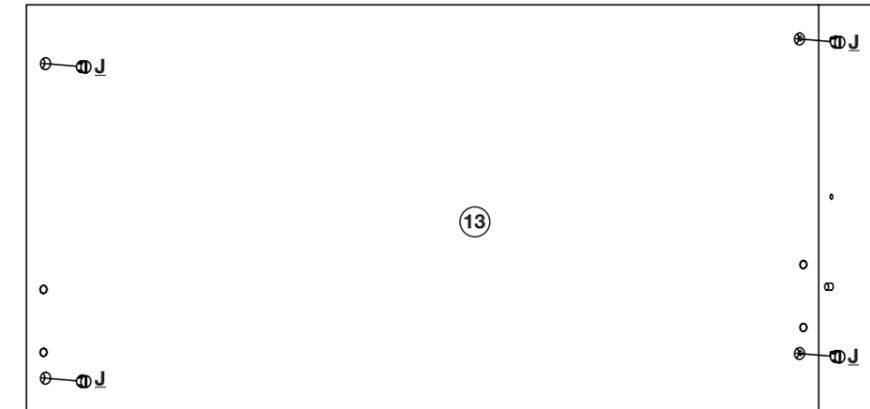
Detalhe colocação da porca cilíndrica (J) na cabeceira do báu (13).
