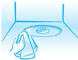
**4** Encaixe o suporte do prato giratório na cavidade, no centro do forno. As roldanas são iguais, na parte superior e inferior do suporte, portanto sua posição é indiferente.
