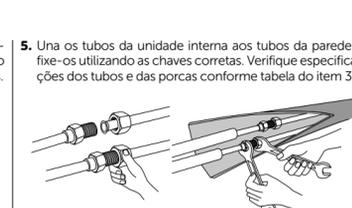
5. Una os tubos da unidade interna aos tubos da parede e fixe-os utilizando as chaves corretas. Verifique especificações dos tubos e das porcas conforme tabela do item 3.7.
