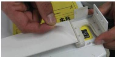
3. Encaixe o suporte traseiro do kit na parte traseira do topo da lavadora e fixando a fita dupla-face no topo.
