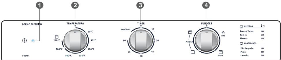
**1 Indicador de funcionamento:** Acende sempre que uma das funções do Forno é selecionada, indicando que o forno ou a lâmpada está em funcionamento.
