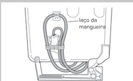
1. Para ajudar a minimizar a vibração, direcione a mangueira de drenagem para evitar contato com o motor, molas da porta, tubulação de água, gabinete, piso ou a borda do orifício onde ela passa através do gabinete.
