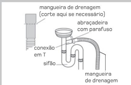
1. Corte a extremidade da mangueira de drenagem se necessário (não corte a parte canelada).
