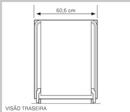
**CONSELHO:** Para locais de instalação que possuam 70 cm de profundidade, é possível ter os pontos de fornecimento de água, energia elétrica e drenagem em qualquer local da face traseira do nicho de instalação.
