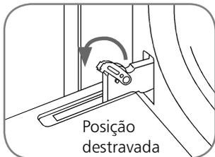
2. Destrave as duas travas da porta Forno que se encontram nas extremidades inferiores da cavidade.
