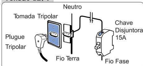
Para a Lavadora-Secadora 127V, utilize um disjuntor de 15A na fase.
