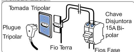
Para a Lavadora-Secadora 220V (entre duas fases), utilize um disjuntor bipolar de 15A.
