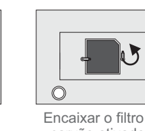
Encaixar o filtro de carvão ativado e girar a trava (modo depurador)
