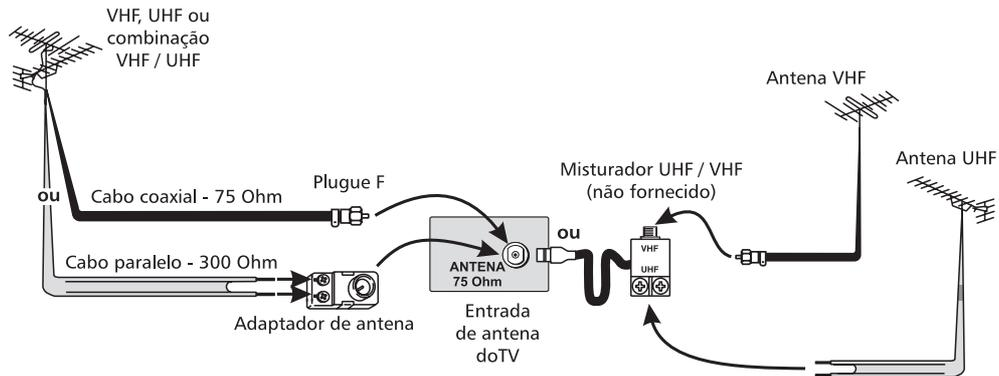
Caso o plugue F não esteja disponível, pode-se ligar a extremidade do cabo coaxial internamente a um adaptador de 300/75 ohm, e fazer a conexão do adaptador à tomada de antena do televisor. Veja a explicação abaixo:
