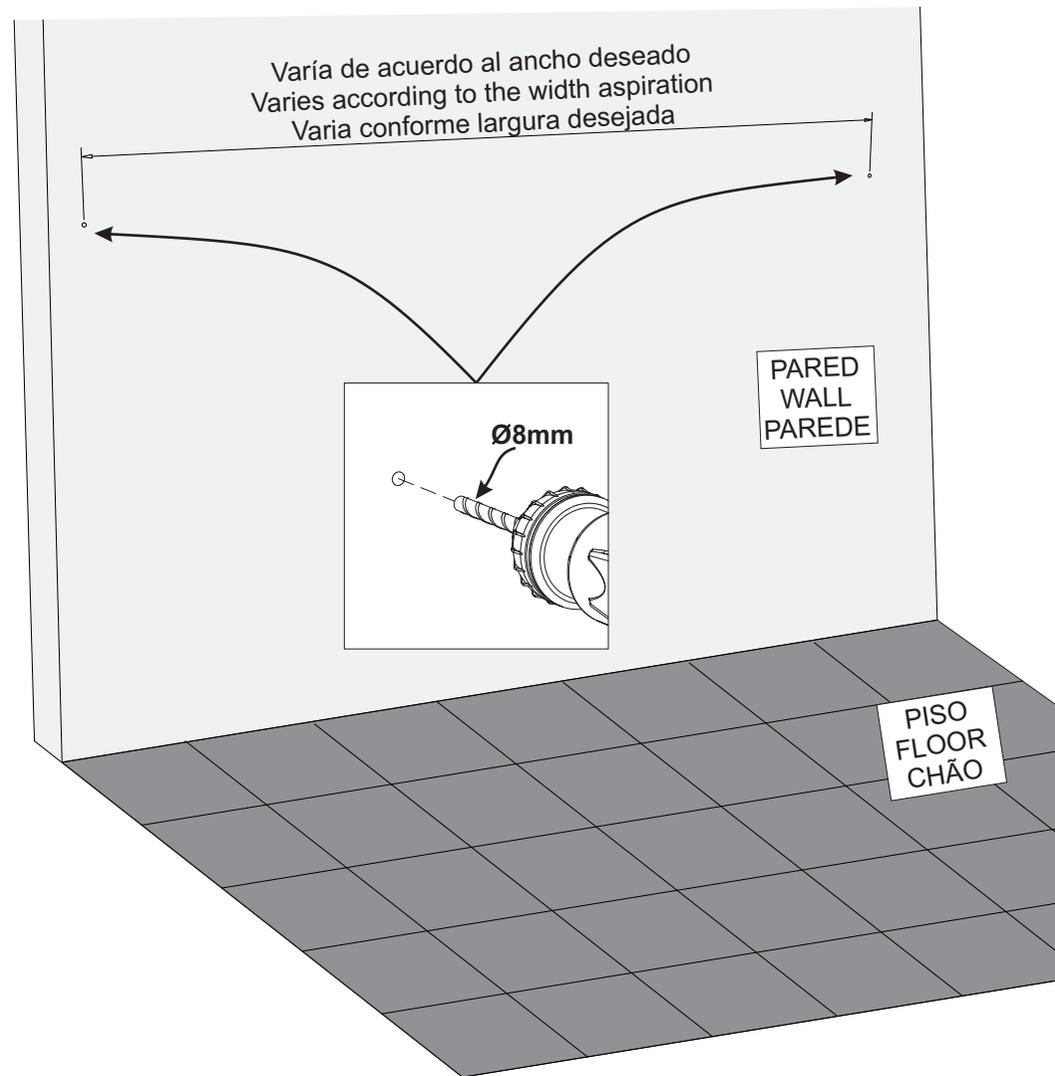
Usando taladro con broca  $\text{Ø}8$  mm, haga agujeros conforme la imagen arriba. Después, encaje el accesorio (C) en los agujeros.
