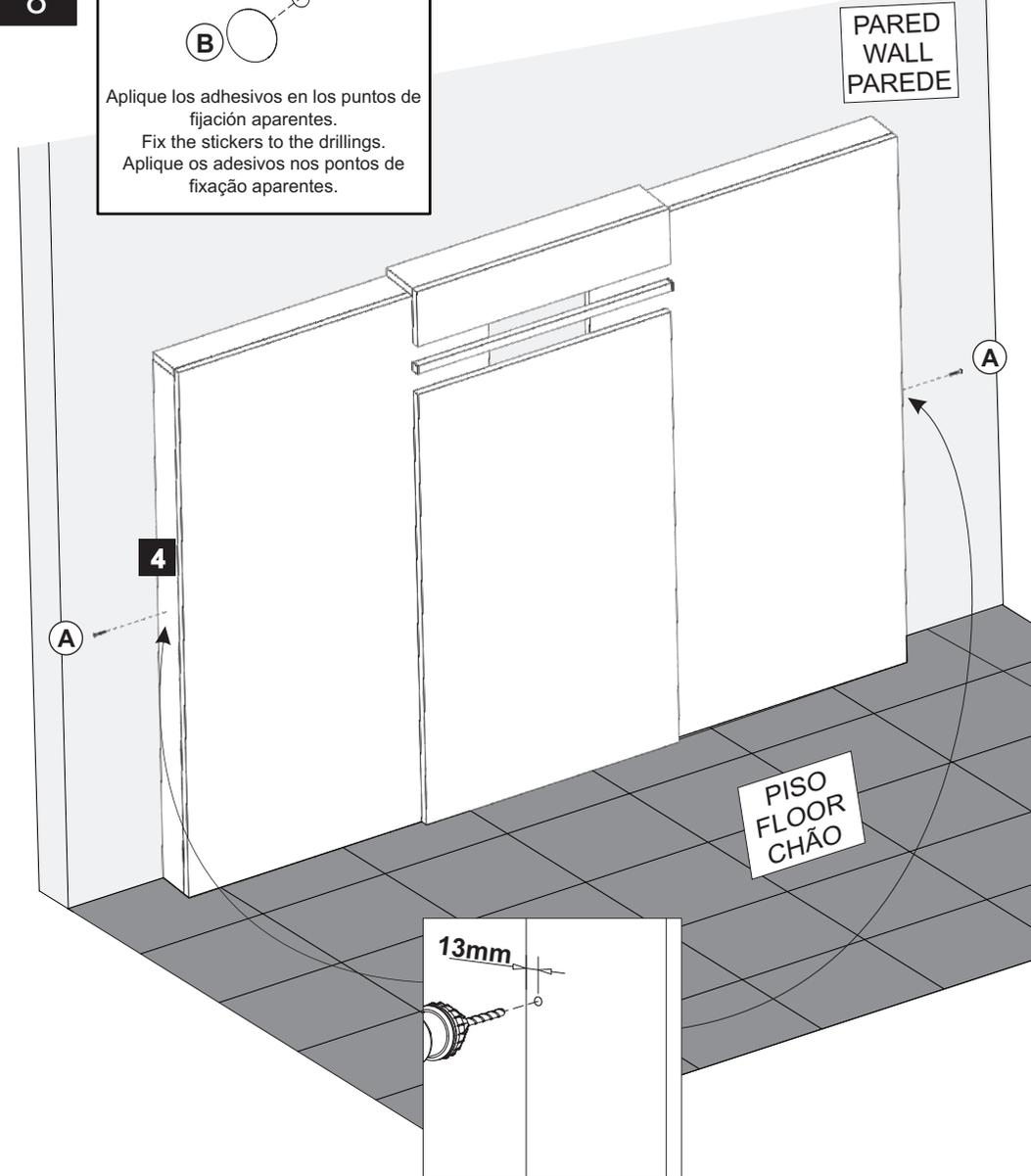
Utilizando Furadeira com Broca  $\varnothing 4\text{mm}$ , faça furações conforme imagem acima.
