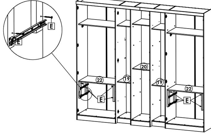
Posicionar o conjunto distanciador + corredeiras encostando o topo superior nos tampos gaveta **22** alinhando a borda do distanciador com a borda dos tampos. Fixar os conjuntos com parafusos 3,5x35 CF **E**.
