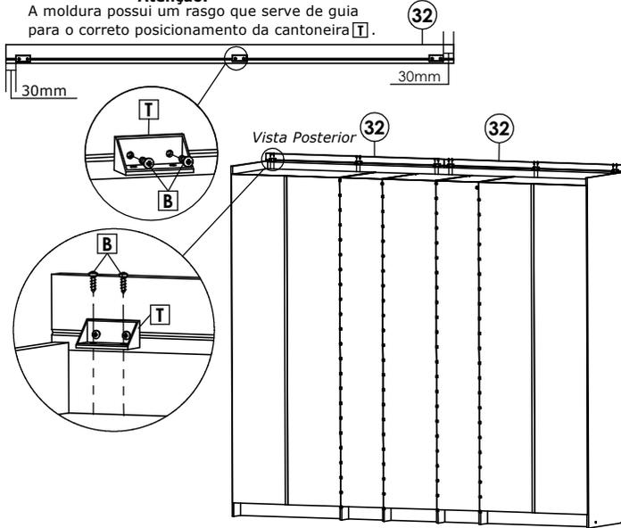
Primeiro faça a fixação das cantoneiras **T** na moldura **32** posicionando duas a 30mm das laterais e a terceira no centro da moldura. Alinhar o centro do rasgo com o centro do parafuso **B** e depois fixe as molduras no produto.
