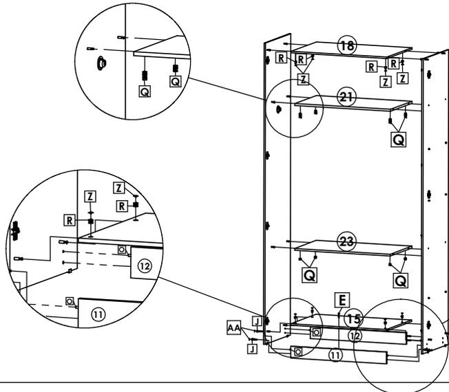
Use a cavilha **Q** + parafusos **J** para fixar a frente pé **11** e cavilhas **Q** e **P** + parafuso **J** para o traseiro pé **12**.
