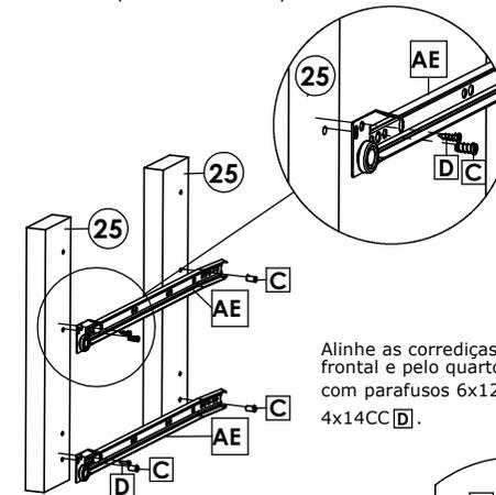
Alinhe as corredeiras pelo segundo furo da parte frontal e pelo quarto furo da parte traseira. Fixe-as com parafusos 6x12CC e parafuso de segurança 4x14CC.
