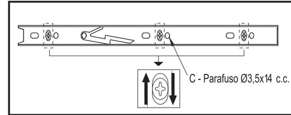
**Espaço livre na horizontal:** Retire a gaveta, desparafuse a corrediça na lateral do móvel, regule conforme a necessidade e parafuse novamente. Coloque novamente a gaveta no móvel, caso a folga esteja correta favor retirar novamente a gaveta e aplicar mais (um) parafuso na corrediça, usando o furo fixo conforme desenho.
