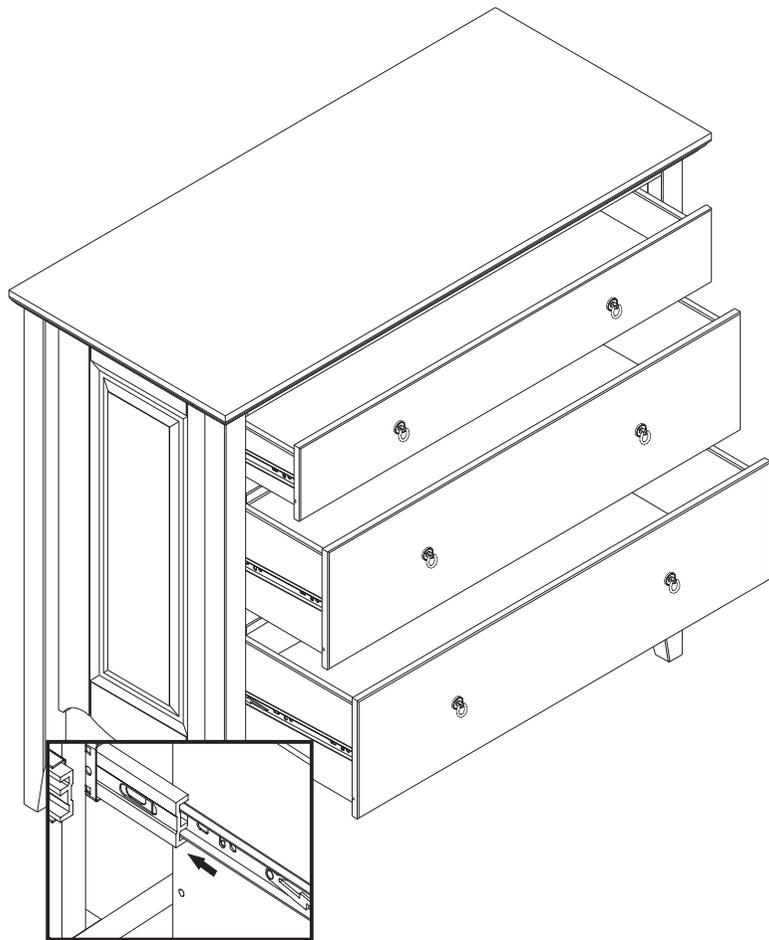
**PASSO 2:** Após fixo nas gavetas e nas laterais do móvel, encaixar a gaveta nas corrediças fixas nas laterais, empurrando-a.
