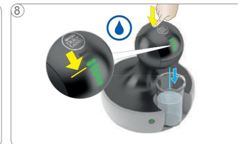
Toque na posição fria. As luzes começam a desligar. A máquina faz a descalcificação em operação liga e desliga por aproximadamente 2 minutos até que o reservatório de água esteja vazio.
