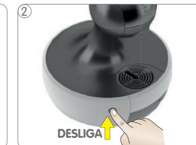
Desligar a máquina. Se houver, retire a água do reservatório de água.
