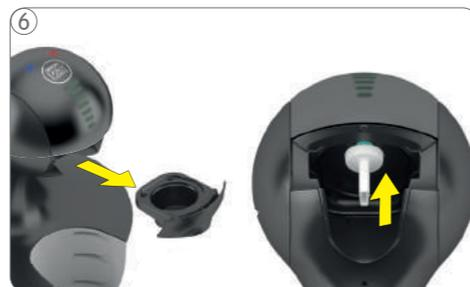
Remova o suporte para cápsula. Empurre a alavanca de perfuração por cima do injetor.
