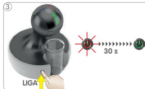
3 Ligar a máquina. Enquanto a máquina aquece, o botão liga/ desliga pisca vermelho. Após aprox. 30 segundos o botão liga/desliga acende uma luz verde e a máquina está pronta para o uso.
