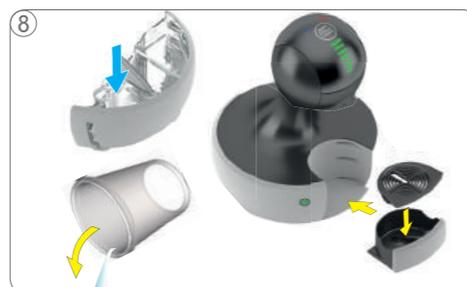
8 Esvazie o recipiente. Torne a encher o reservatório com água potável fresca. Recoloque o reservatório de água na máquina. Coloque o suporte para xícaras no suporte de gotejamento. Então coloque o suporte de gotejamento na posição desejada.
