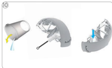
Esvazie e limpe o recipiente. Lave e limpe o reservatório de água. Utilize uma escova limpa e detergente se necessário. Em seguida, encha-o com água potável fresca e coloque-o na máquina.
