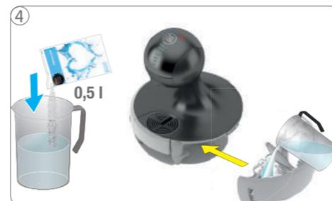
Misture 0,5 litro de água potável fresca com o conteúdo do sachê (descalcificante) num copo medidor. Verta a solução descalcificante no reservatório de água e coloque-o na máquina. No Brasil não é necessário fazer o processo de descalcificação.
