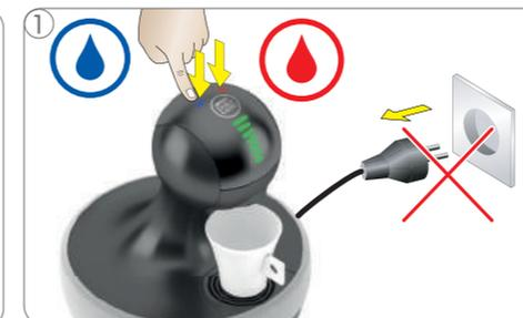
**Sempre mantenha a máquina em pé!** Para interromper o preparo, toque no ícone quente/frio novamente. Não tire o cabo de força da tomada! A máquina libera pressão.
