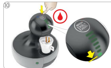
Apertar o botão para quente (ou frio - dependendo da bebida). Começa o preparo da bebida. Permaneça ao lado da máquina durante a preparação. As luzes do display de luz apagam-se progressivamente. A máquina para a preparação.
