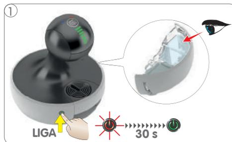
Verifique se o reservatório de água contém água suficiente. Ligar a máquina. Enquanto a máquina aquece, o botão liga/desliga pisca vermelho. Após aprox. 30 segundos o botão liga/desliga acende uma luz verde e a máquina está pronta para o uso.
