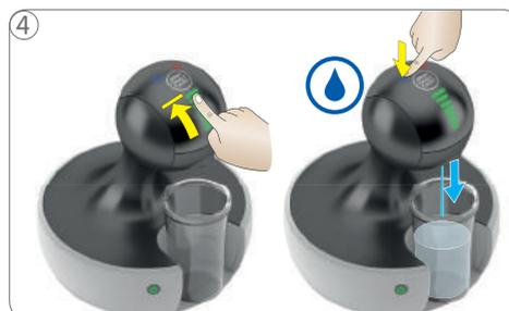
4 Iniciar enxague com água fria. Regule o display de luz no nível máximo através do seletor de volume. Toque na posição fria. A máquina inicia a lavagem.
