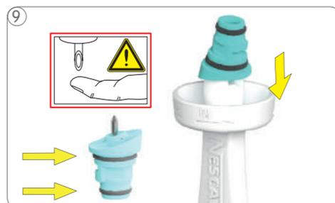
Verifique se ambos os anéis tóricos estão intactos e encontram-se corretamente posicionados no injetor. Coloque o injetor na alavanca de perfuração.
