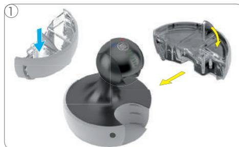
1 Lavar e enxaguar o reservatório de água com água potável fresca. Encher o reservatório com água potável fresca. Colocar a tampa e instalar o reservatório na máquina.
