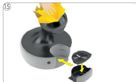
Limpe a máquina com um pano macio úmido. Em seguida seque com um pano seco. Coloque o suporte para xícaras no suporte de gotejamento. Então coloque o suporte de gotejamento na posição desejada na máquina.
