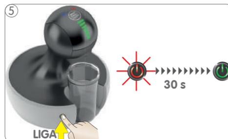
Ligar a máquina. Enquanto a máquina aquece, o botão liga/ desliga pisca vermelho. Após aprox. 30 segundos o botão liga/desliga acende a luz verde. A máquina está pronta para o uso.
