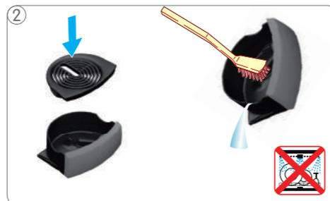
Enxague o suporte de gotejamento com água potável fresca e limpe-o com uma escova limpa.
