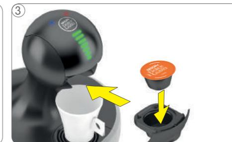
3 Retire o suporte para cápsula. Insira uma cápsula no suporte para cápsula e recoloque o suporte para cápsula na máquina.
