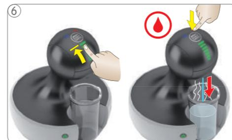
Enxague a máquina. Selecionar no display de luz o nível máximo. Toque na posição quente. A máquina inicia a lavagem. As luzes apagam gradativamente.
