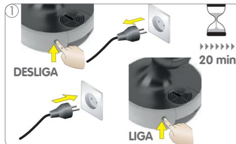
Desligar a máquina. Verifique se a cápsula está obstruída, consulte "9.2 LÍQUIDO NÃO SAI – CÁPULA / INJETOR BLOQUEADO?" na página 15. Tire o plugue da tomada e aguarde 20 minutos. Em seguida, torne a ligar o cabo de força na tomada e ligue a máquina.
