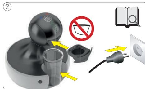
2 Colocar o suporte para cápsulas vazio. Colocar um recipiente grande vazio debaixo da saída de café. Verificar se a tensão elétrica do aparelho corresponde à tensão elétrica conforme "2. APRESENTAÇÃO" na página 5. Conectar o cabo de força do seu aparelho à tomada.
