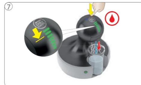
Toque na posição quente. As luzes começam a desligar. A máquina faz a descalcificação em operação liga e desliga por aproximadamente 2 minutos. Aguarde até que a extração pare.
