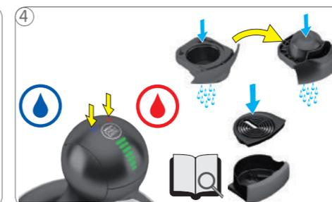
Enxague a máquina. Para isso, siga as instruções contidas em "5. PRIMERA UTILIZAÇÃO" na página 8. Limpe com detergente líquido e água potável e fresca ambos os lados do suporte para cápsula. Enxague o suporte de gotejamento com água potável fresca e limpe-o com uma escova limpa.
