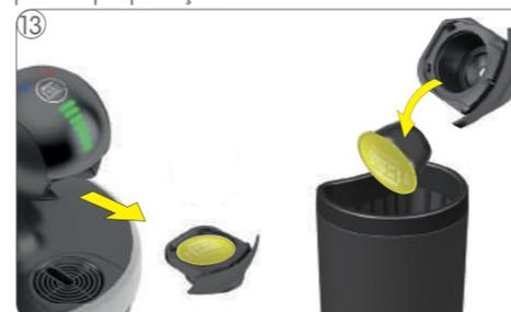
Retire o suporte para cápsula e tire a cápsula utilizada. Coloque a cápsula usada no depósito de cápsulas utilizadas
