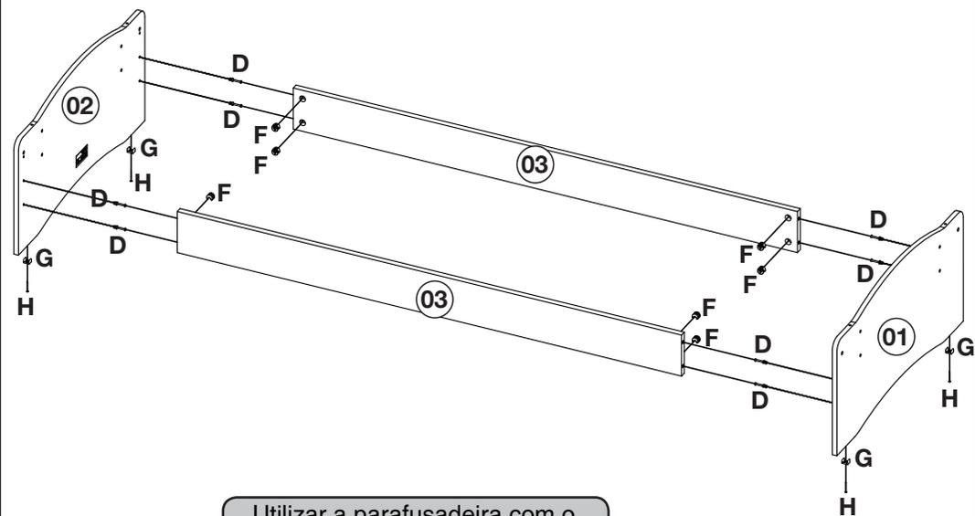
Utilizar a parafusadeira com o torque em 15 para fixar as grades e para fixar o lastro.
