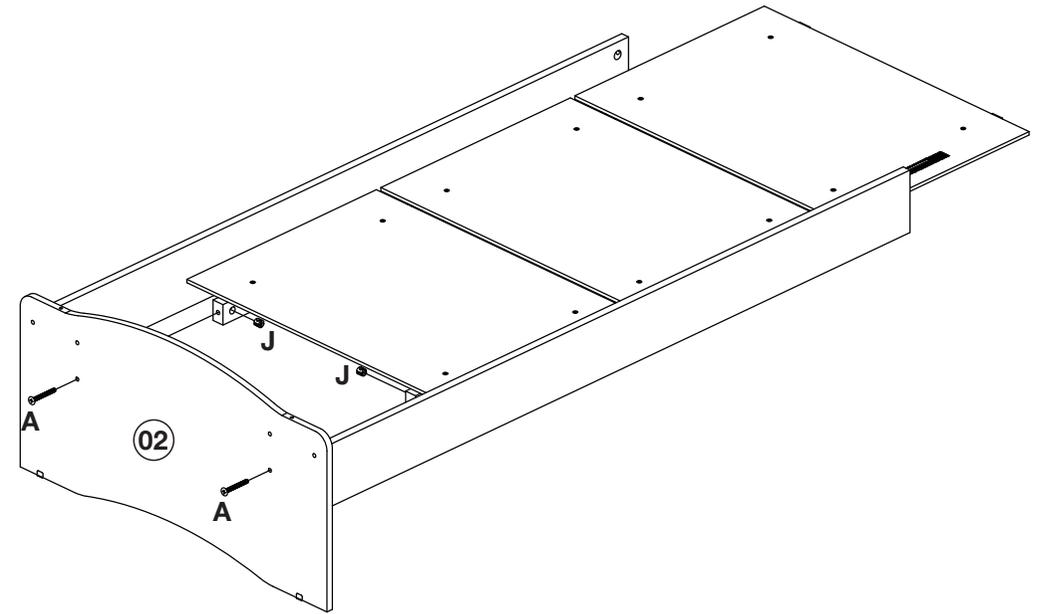
Para a montagem da Mini cama é necessário utilizar a peça de nº 02 para a montagem da peseira e a peça de nº 06 para a montagem da cabeceira.
