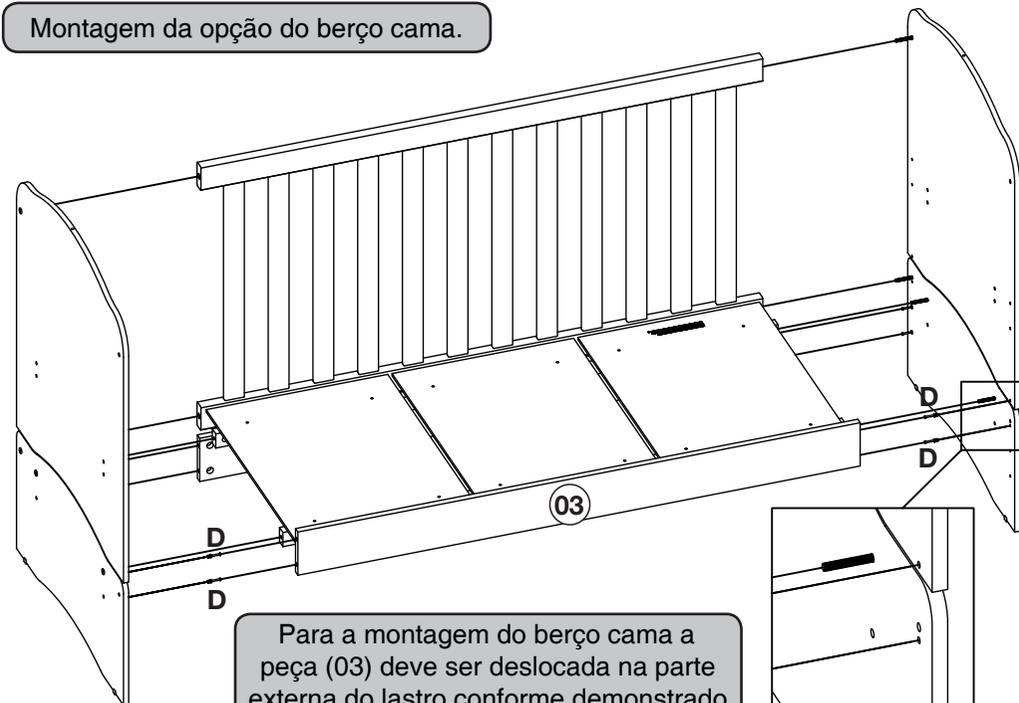
Para a montagem do berço cama a peça (03) deve ser deslocada na parte externa do lastro conforme demonstrado acima.
