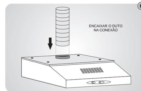
C) Encaixar o duto flexível na conexão após a fixação na prateleira (MODO EXAUSTOR). Na instalação do duto, o mesmo não deve ultrapassar 1,5 metros até a saída externa, para que o produto não perca eficiência de vazão.
