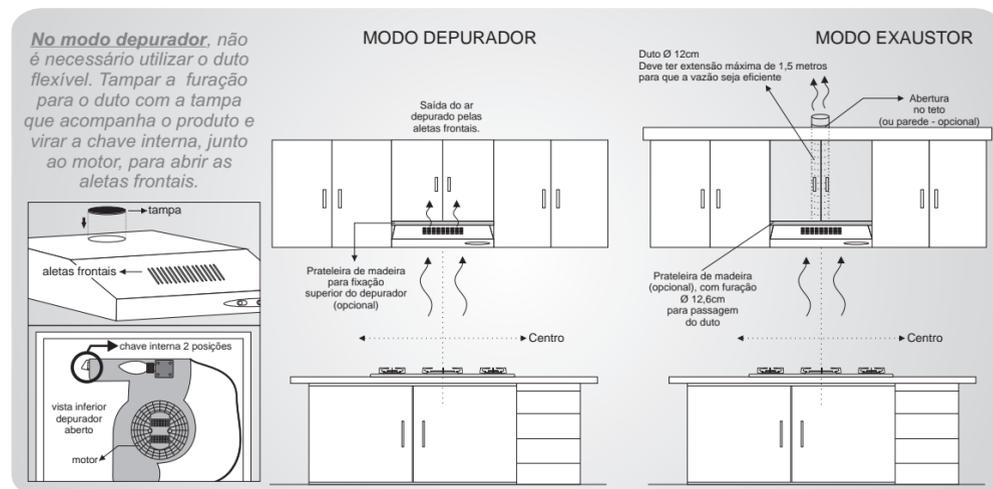
NOTA: Para fixação, centralizar o depurador ao fogão. Com uma trena, achar a altura entre o fogão e a base do depurador, conforme indicado neste manual (65 a 80 cm). O duto não deve ultrapassar 1,5 metros até a saída externa, para que a vazão de ar seja eficiente.
