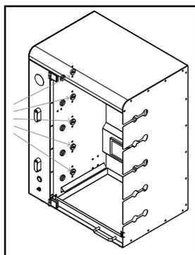
O usuário mensalmente deve pingar de duas a três gotas de óleos nos mancais internos figura ao lado para melhor funcionamento. Cuidar para não escorrer dentro do assador;
