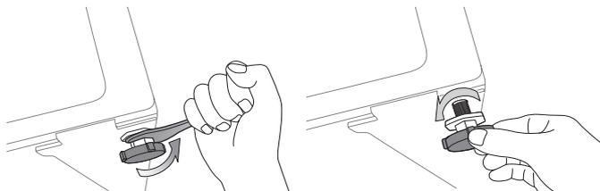
3. Quando a lavadora estiver nivelada, aperte as porcas usando a chave de boca fornecida junto com a mesma.
