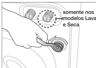
2. Segure no parafuso com a chave de fenda e puxe-o pela seção mais larga do orifício. Repita para cada parafuso.
