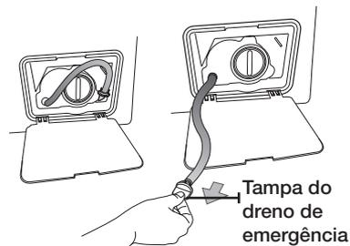
4. Segure a tampa na ponta do tubo de drenagem de emergência e puxe-a vagarosamente.
