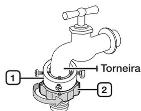
4. Conecte a mangueira de entrada de água ao adaptador. Ao liberar a parte (3), a mangueira se conecta automaticamente ao adaptador, fazendo um som de "clique".
