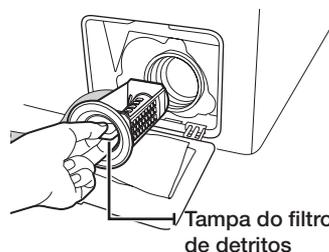
5. Limpe o filtro de detritos, retirando qualquer sujeira ou outros materiais. Verifique se a hélice de bombeamento de drenagem atrás do filtro de detritos não está bloqueada.
