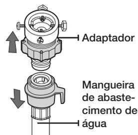
2. Primeiro, utilize uma chave de fenda do tipo "+" e solte os quatro parafusos do adaptador. Em seguida, pegue o adaptador e gire a parte (2), seguindo a seta, até que haja um espaço de 5 mm.
