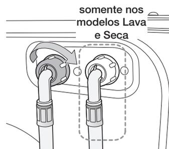
6. Abra o abastecimento de água e verifique se não há vazamentos na válvula de água, torneira ou adaptador. Caso haja vazamentos, repita as etapas anteriores.
