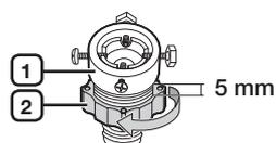
3. Conecte o adaptador à torneira apertando os parafusos firmemente enquanto puxa o adaptador para cima. Gire a parte (2) seguindo a seta e conecte (1) e (2).
