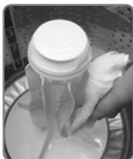
5. Com um pano umedecido com água e sabão neutro limpe a parte externa do agitador.
