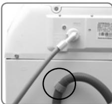
9. Instale a mangueira de saída de água no tanque ou em um tubo exclusivo para escoamento, com diâmetro de 5 cm. Para instalação em tanque, mantenha a curva plástica que acompanha a extremidade da mangueira. Para instalação em TUBO DE ESCOAMENTO, retire a curva plástica, empurrando a mangueira para dentro da curva plástica e, em seguida, para cima. A mangueira deverá ser colocada no máximo 20 cm no tubo de escoamento.
