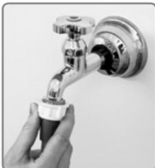
10. Rosqueie a mangueira de entrada de água na torneira, aperte o suficiente para não haver vazamento. Abra a torneira. Caso ocorra vazamento, reaperte as conexões. Não utilize veda-rosca nas conexões da mangueira.
