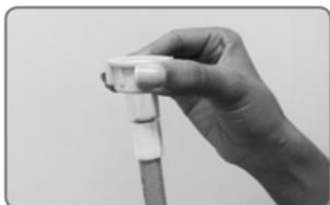
4. Puxe o conector da mangueira para cima, recoloca o filtro na mangueira e posicione o anel de vedação dentro do conector. Conecte novamente a mangueira na torneira.
