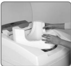
1. Retire a Lavadora da embalagem, a proteção interna e os acessórios que vêm dentro dela. Retire a etiqueta de eficiência de energia que vem fixada na frente do gabinete.
