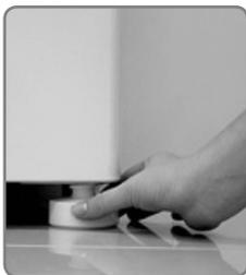
**13.** Para determinar se a máquina está NIVELADA corretamente, fique de frente para o produto, apóie as duas mãos na lateral próxima a tampa e balance. Se o produto balançou ainda não está bem nivelado. Nivele sua Lavadora através do ajuste dos pés reguláveis. Para ajustar os pés gire para a direita para aumentar a altura. Gire para a esquerda para diminuir a altura. Todos os pés devem estar apoiados no chão. Este procedimento evitará trepidações, barulho, vazamento e desgaste de sua Lavadora.
