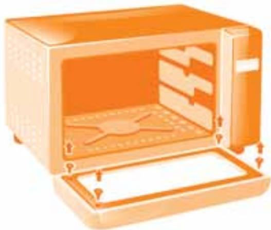
1. Em uma superfície plana, abra a porta e remova os quatro parafusos que fixam a contraporta ao painel da porta.
