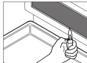
a) - Nos modelos AGR-05, AGRA-05, AGR-03 e AGRA-03, não havendo vazamentos, acenda o queimador. Libere o gás girando o botão frontal na posição máxima e coloque fogo com fósforo ou isqueiro (figura 04), pela tela frontal da churrasqueira.
